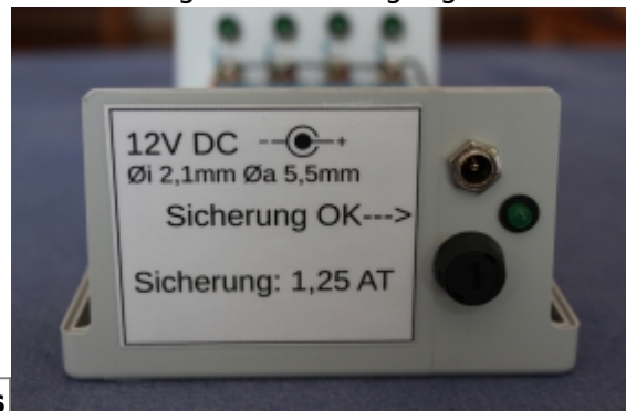
Beschriftung der Spannungsversorgung
